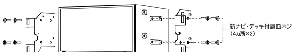
2. 純正ホルダー(L)(R)を取り付け、付属ナットで固定します。(4カ所×2)
