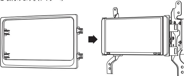
5. 新ナビ・デッキを車両に取付け、残りの純正パーツを取り外したときと逆手順で組み付けてください。
