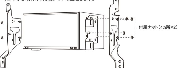
3. サイドパネル(L)(R)の両面テープ剥離紙を剥がし、新ナビ・デッキの側面に貼付けてから付属ネジで固定します。(2カ所×2)
