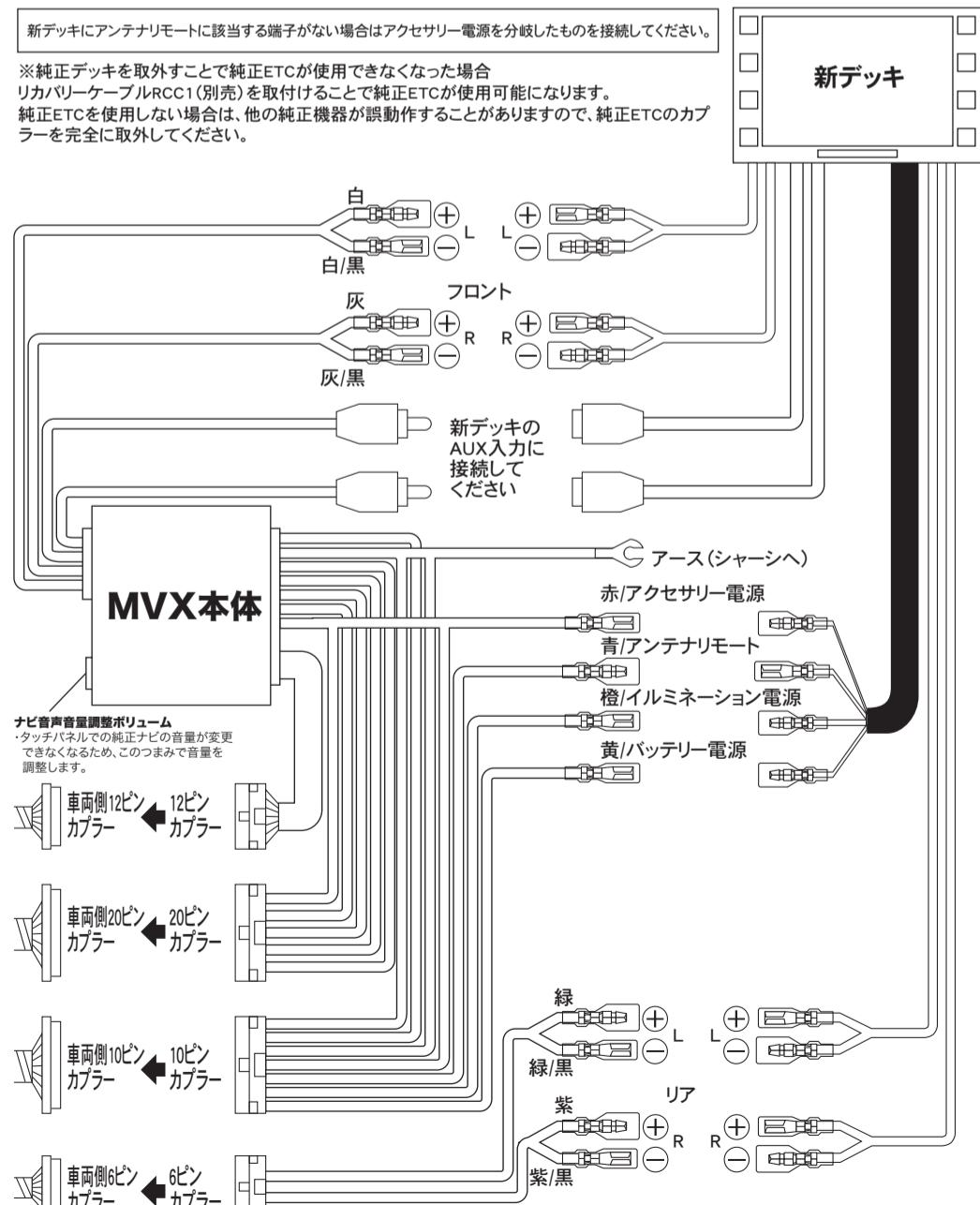
・アダプターのRCA(赤/白)ケーブルから出力される音声は、純正アナログTV音声及び、純正外部入力に接続された機器の音声になります。
