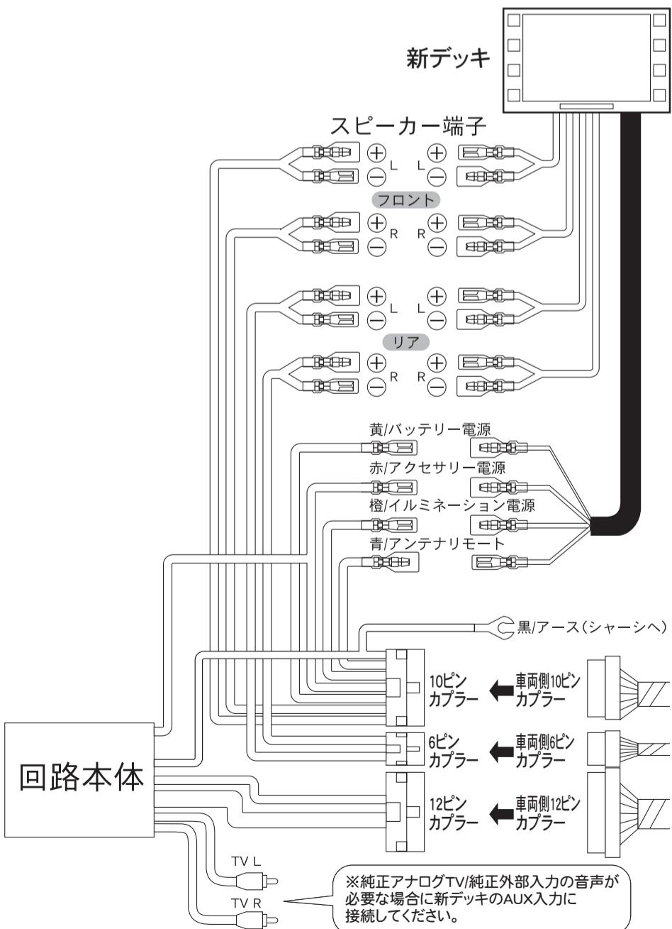
アダプターのRCA(赤/白)ケーブルから出力される音声は、純正アナログTV音声及び、純正外部入力に接続された機器の音声になります。
